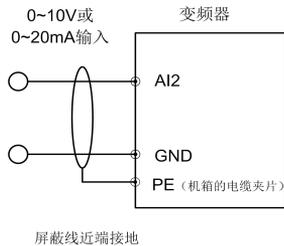
图 3-14 模拟输入端子配线图
