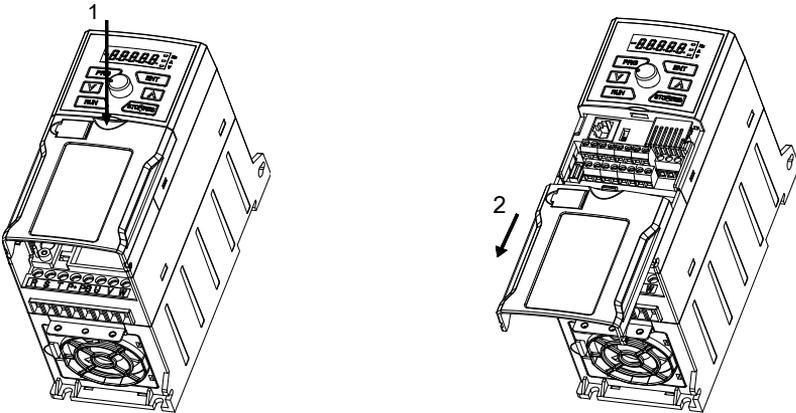
图 3-9 盖板的拆卸
