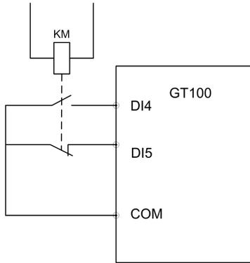
图6-23 外部设备故障常开/常闭输入示意图
