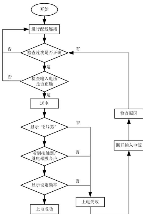
图 4-8 变频器初次上电操作流程
