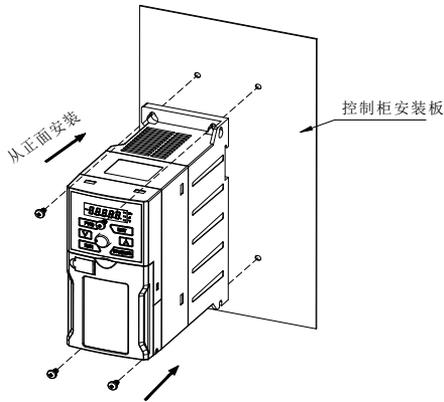
图 3-3 塑胶结构壁挂式安装示意图
