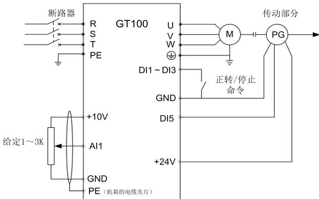
图6-34 PG速度闭环控制系统接线图
