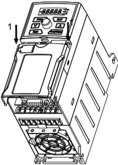
图 3-6 盖板的拆卸
