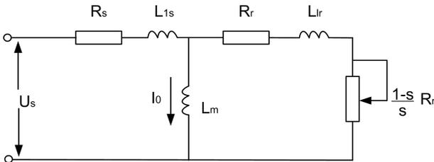
图6-14 异步电机稳态等效电路图
