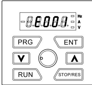
图 4-6 加速中过流故障报警显示
