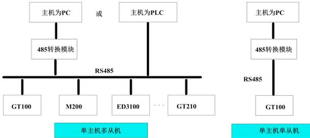
附图1 变频器组网方式示意图
