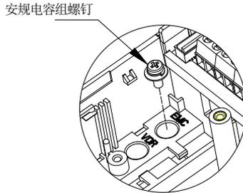
图 3-12 安规电容（EMC）短接螺钉位置示意图
