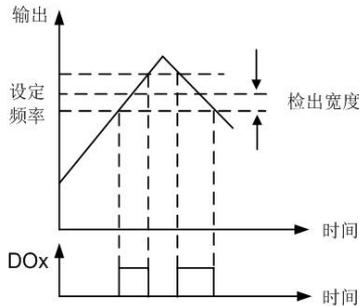
图6-29 频率到达信号输出示意图
