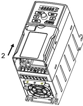
图 3-7 盖板的安装
