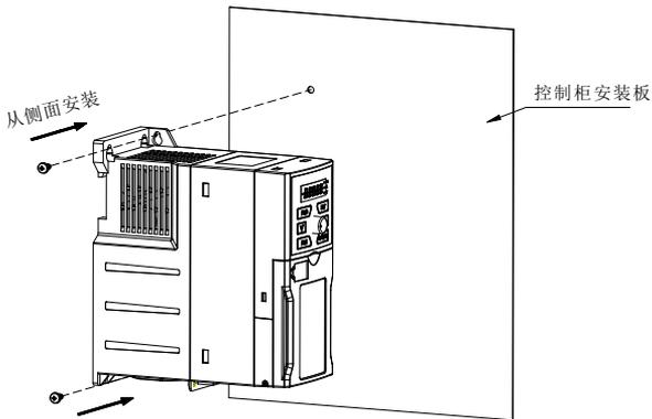
图 3-4 塑胶结构壁挂式安装示意图
