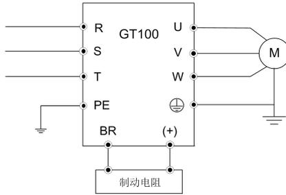
图 2-2 变频器与制动组件接线图
