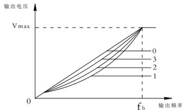
Vmax: 最大输出电压 F3.05      fb: 基本运行频率 F3.04
