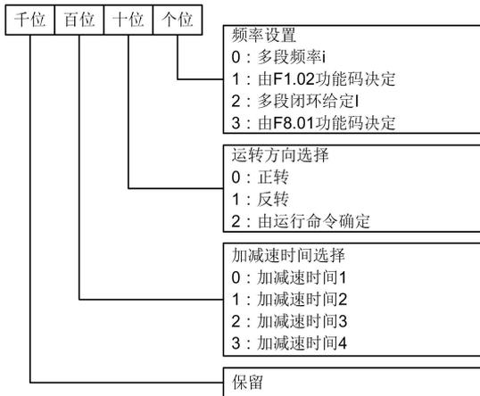
图6-49 PLC阶段 $i$ 设置 ( $i=1\sim 15$ )
