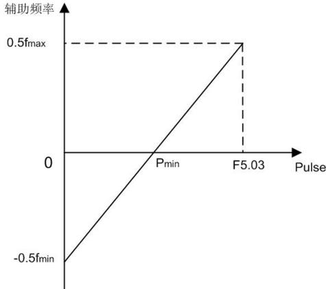
$P_{min}$ —1/2 \*最大输入脉冲频率（F5.03）
