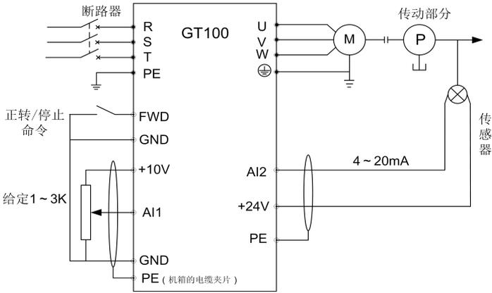
图6-33 内置PI模拟反馈控制系统示意图
