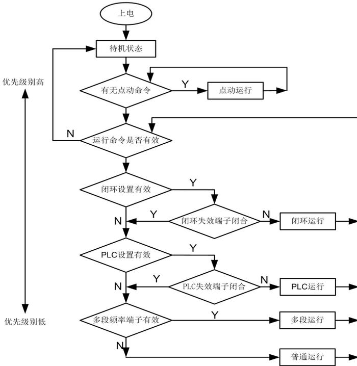
图 4-1 变频器运行状态的衍变逻辑
