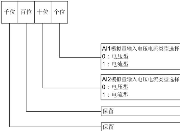
图 6-20 模拟量输入采样设置
