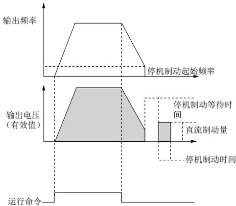
图6-11 减速停车+直流制动示意图
