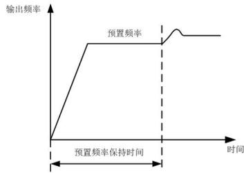
图6-41 闭环预置频率运行示意图
